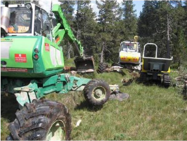
2 Schreitbagger Menzi Muck A 91 mit speziellen Moortatzen und 1 Raupendumper der Firma Roos Bau AG, Romoos, bereit für den Einsatz. Foto links: Erwin Meier, 24.8.2009
