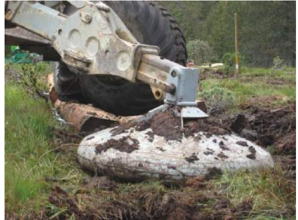
2 Schreitbagger Menzi Muck A 91 mit speziellen Moortatzen und 1 Raupendumper der Firma Roos Bau AG, Romoos, bereit für den Einsatz. Foto links: Erwin Meier, 24.8.2009
